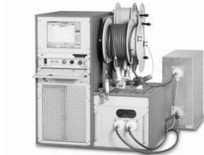
Рис. 14. Универсальная система регистрации частичных разрядов
